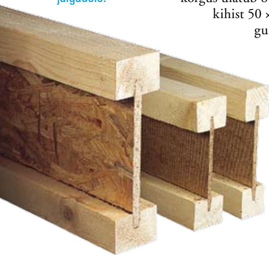
Foto 4. Kergtala, tõmbe- ja survevõõ on teineteisest eemal ja ühendatud OSB-st plaadiga. Võrdle fotoga 2: neljakihilise kooriku alumised kaks kihti on ülemistest distantsklotside abil eemale viidud.
