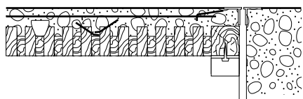
Joonis 9. Üks puit-betoonisilla lahendusi, dekikonstruktsioonis on kasutatud puitlamellplaati.
