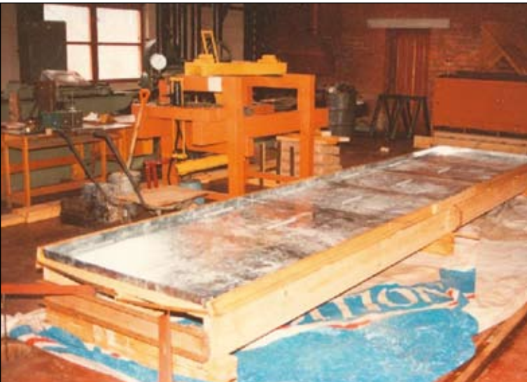
Joonis 6. Spetsiaallogaplaatidest sidemetega puit-betoonpaneeli katsetamine TTÜ laboris.
