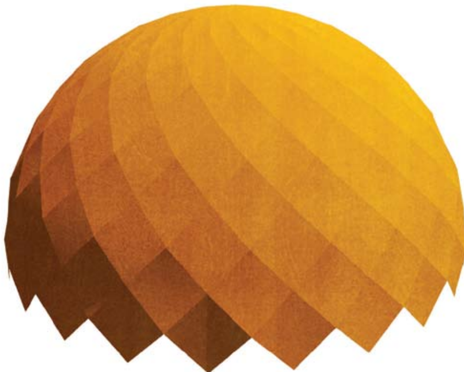
Pilt 8. Suurpaneelidest kupli saab ehitada käbi soomustikku meenutava pöördkujundina.
