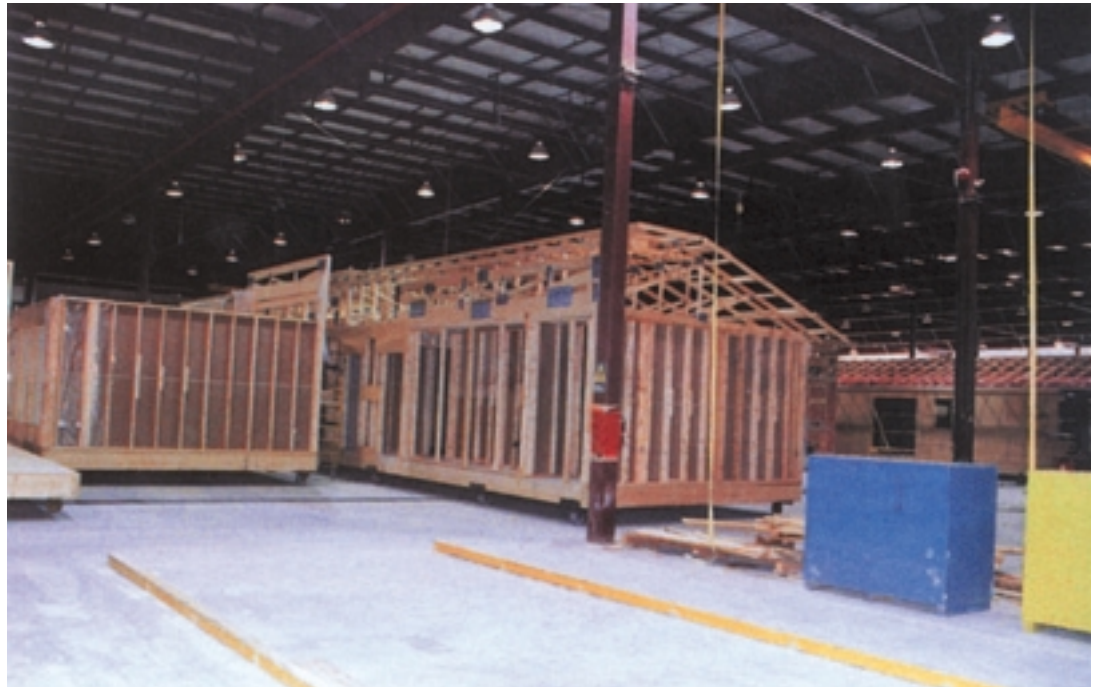
“Ehituskastisüsteemis” maja kokkusobitamine tehases.
