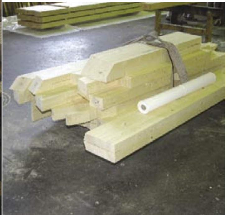
Foto 6. Liimpuitsõrestiktalade detailid saetakse välja CNC-juhtimisega sael, nurgad on täpsed ega vaja sobitamist.
