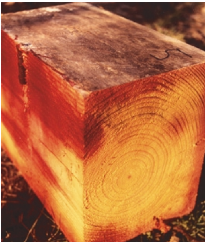
Boracoliga töödeldud puidu ristlõige neli aastat hiljem. Puit on immutatud puuraugu meetodil ja Boracoliga kergelt üle pintselatud.
