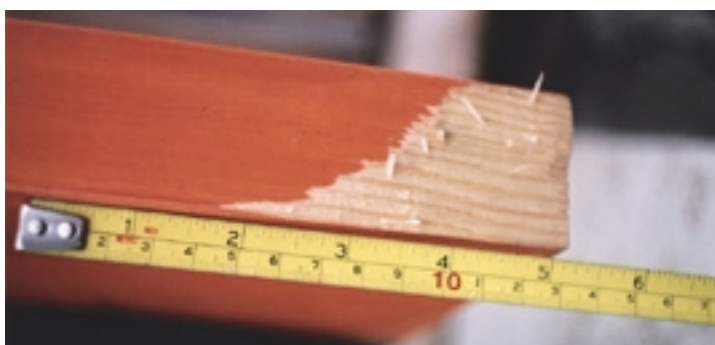
Pinotex ULTRA imbumisvõime on samaväärne hariliku Pinotexiga . Eeliseks on paremad vetthüljavad omadused.
